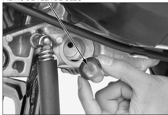
TAMPA DO FILTRO DE TELA DE ÓLEO ANEL DE VEDAÇÃO FILTRO DE TELA DE ÓLEO
